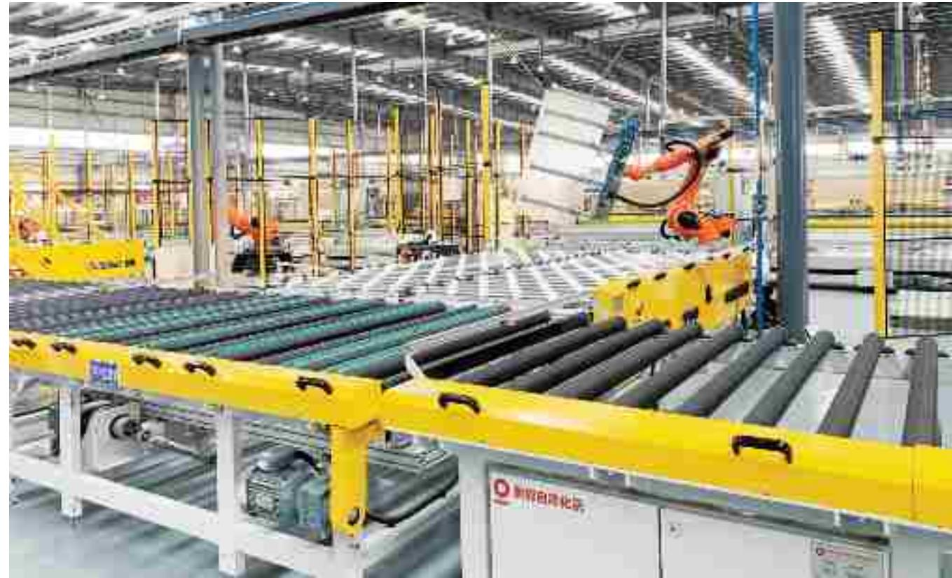
特种玻璃智能化生产线装备及系统——机器人下片铺纸系统。
