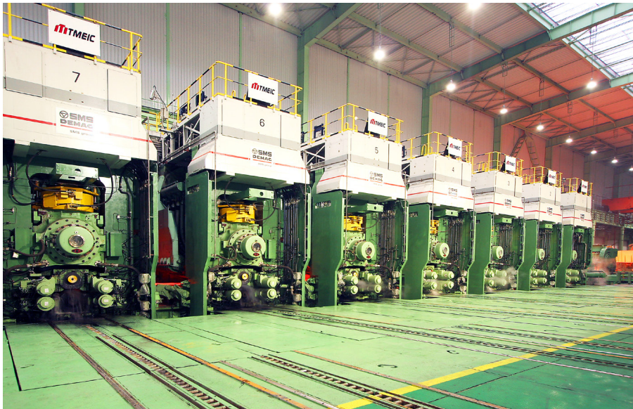
国内最宽幅热连轧机组—2300mm 热连轧机组
