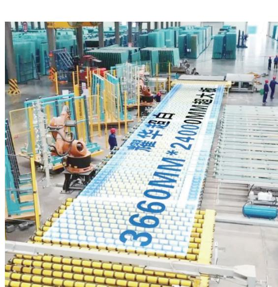
7月12日，中国建材集团所属凯盛科技耀华中联玻璃一次性成功生产下线15mm×366m×24m的超白玻璃，突破了缺陷控制、退火质量、完整去边、吊装储运等核心技术难题，一举打破了世界超白玻璃原片制造纪录，单片玻璃878平方米，重达33吨，成为中联玻璃调整产品结构与新产品开发的又一次成功实践，开启了又一个新篇章。
